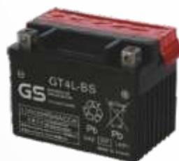
Аккумуляторные батареи серии GS Maintenance Free AGM обладают улучшенной свинцово-кальциевой технологией и низким внутренним сопротивлением сепараторов, за счет этого обеспечивается повышенная производительность при старте даже при низкой температуре. Сепараторы из стекловолокна абсорбируют электролит и обеспечивают полную герметичность. AGM-батареи максимально виброустойчивы, не требуют доливки и обладают низкой степенью саморазряда.
